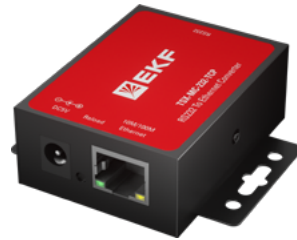
TSX-MC-232-TCP • Преобразователь RS-232 в Ethernet • Один порт RS232 (DB9) • Один 100Мбит/с медный порт, RJ45, • Поддерживаемые сетевые про- токолы: TCP, UDP, DHCP, DNS, HTTP, ARP, ICMP • Питание 5В/ 150мА DC
