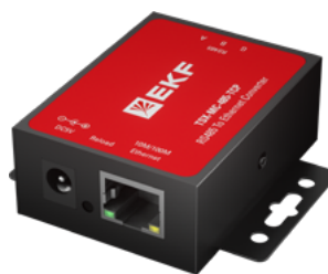
TSX-MC-485-TCP • Преобразователь RS-485 в Ethernet • Один порт RS-485, 2 провода (A+, B-) • Один 100Мбит/с медный порт, RJ45, • Поддерживаемые сетевые про- токолы: TCP, UDP, DHCP, DNS, HTTP, ARP, ICMP • Питание 5В/ 150мА DC
