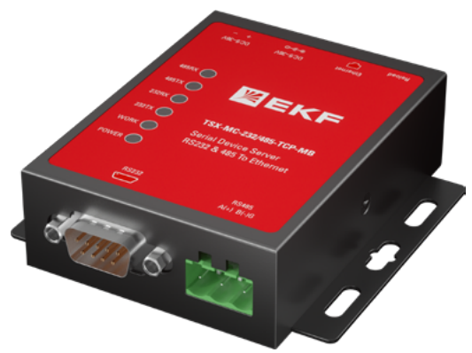
TSX-MC-232/485-TCP-MB • Преобразователь RS-232/485 в Ethernet • Один порт RS-485, 2 провода (A+, B-) • Один порт RS232 (DB9) • Один 100Мбит/с медный порт, RJ45, • Поддерживаемые сетевые протоколы: TCP, UDP, DHCP, DNS, HTTP, ARP, ICMP, Web socket, HTTPD Client, Modbus TCP/Modbus RTU • Питание 5В/90мА или 12В/50мА DC
